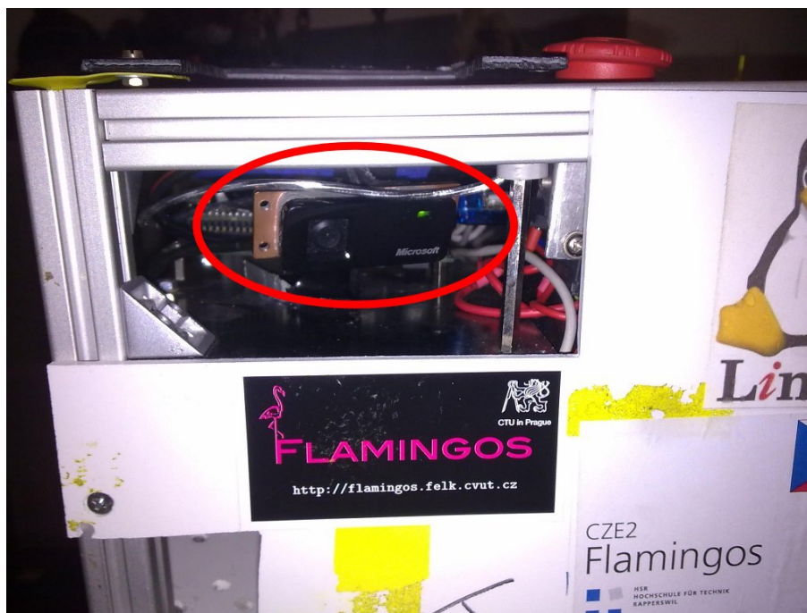
Obrázek 3.3: Umístění kamery na robota.
